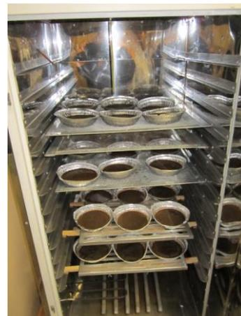
Figura 11. Estufa de circulação forçada utilizada para secagem das amostras
