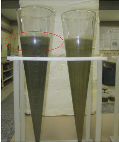
Figura 1. Análise de sedimentação (60 minutos) em destaque a camada de óleo formada na superfície do substrato.
