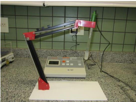
Figura 10. Phmetro de bancada utilizado para as determinações
