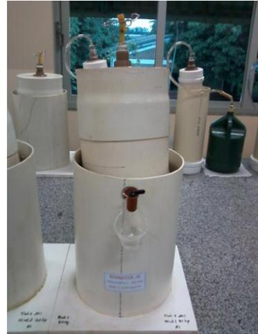
Figura 2. Biodigestor batelada utilizado no experimento
