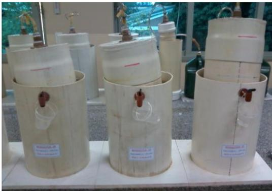
Figura 3. Disposição dos biodigestores na bancada do laboratório.
