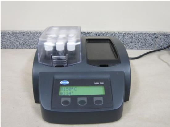
Figura 6. Digestor utilizado para análise de DQO.
